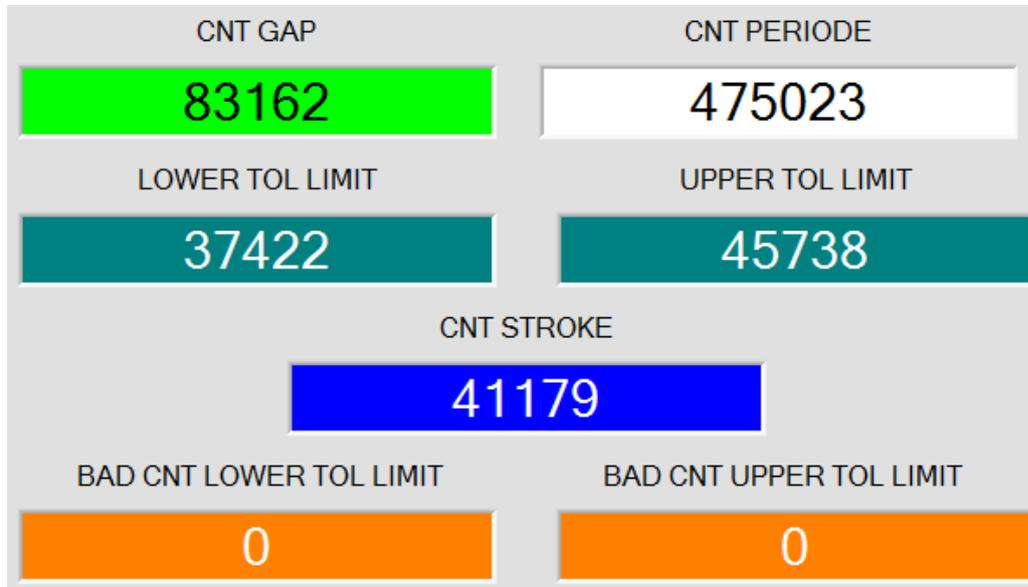
In diesen Displays wird angezeigt, bei welchem Zählerstand ein Ereignis eingetreten ist. Der Zählerstand entspricht fast genau einer Angabe in Mikrosekunden.
