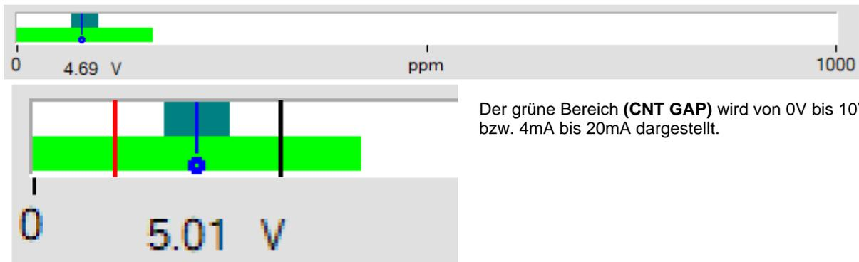
Wenn der Cursor (**Stanzhub CNT STROKE**) auf Position der blauen Linie steht, wird 5V bzw. 12mA ausgegeben.
