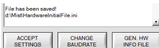
Über den Button **GEN. HW INFO FILE** wird ein File erzeugt, in dem alle wichtigen Sensordaten verschlüsselt hinterlegt werden. Dieses File kann zu Diagnosezwecke an den Hersteller gesendet werden.
